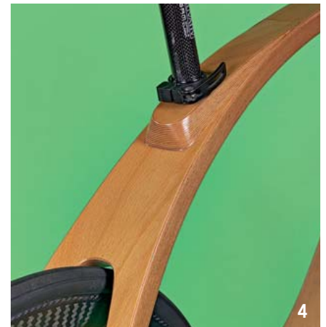
2 Wie am Lenkrohr stabilisiert ein eingeklebtes Stahlrohr die passgenau abgelängte Stattelstütze im Rahmen.
